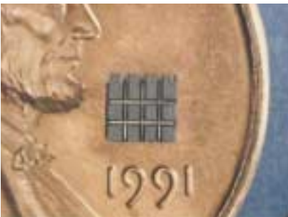
Retinal implant için tasarlanan ilk biyoçip
